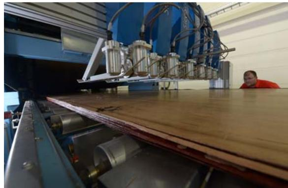
**Bild 9:** Furniere vor dem Pressen links und die fertige Rohplatte am Ende der Presse rechts
