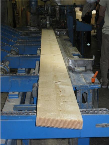
**Abbildung 8: Lamelle mit Keilzinkung**
