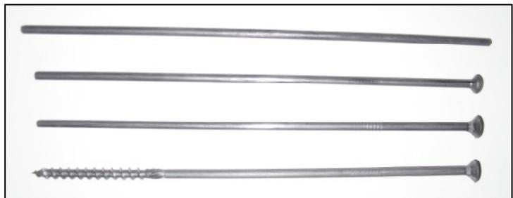
**Abbildung 12: Vom Schraubenrohling bis zur fertigen Schraube**
