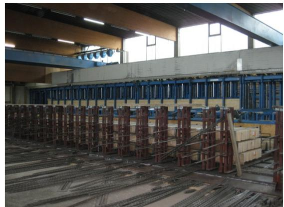
**Abbildung 9: Träger während des Pressens und Aushärtens**
