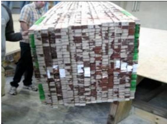
Als besonderes Highlight konnten wir die zweifach gekrümmten Brettschichtholzträger der zweiten Schwerlastbrücke in Sneek begutachten. Das spezielle Accoya-Holz, stammt von einer neuseeländischen Pinienart, die sehr schnell wächst, astarm und splintholzreich ist. Durch eine Behandlung mit Essigacetylrat wird es witterungsbeständig gemacht. Um die zweiachsige
