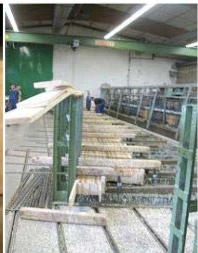
versetzte Anordnung der Böcke realisiert werden. Blockverleimte Träger mit größerer Breite werden in einem weiteren Arbeitsschritt durch Verleimung mehrerer Träger an den Seitenflächen hergestellt.
