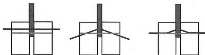
Bild 3: Versagensmöglichkeiten für innen liegende Stahlbleche
