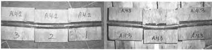
Bild 10: Versagensbilder der 30-mm-Durchmesser-Stahldübel S960
