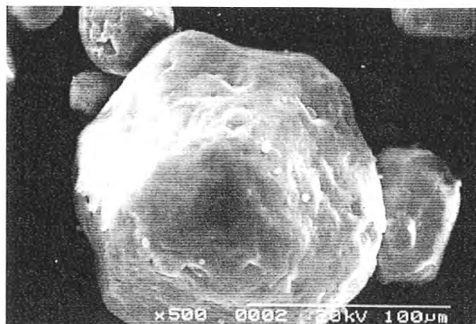
Bild 13: Natriumhydrogenkarbonatpulver (REM, 500-fache Auflösung)
