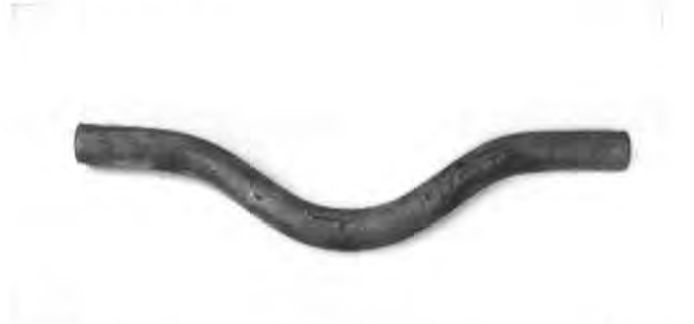
Bild 9: Typisches Bild der Verformungen eines Stabdübels S235 in einer Holzverbindung aus Bongossi/Azobé
