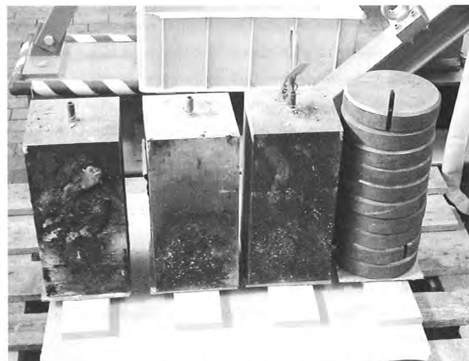
Bild 10: Belastungstest mit 100 kg Gewicht pro Probe
