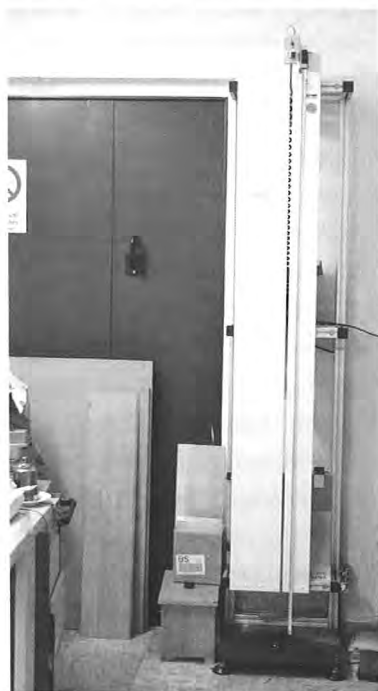
Bild 9: Kugelfalltest in Anlehnung an DIN EN 438
