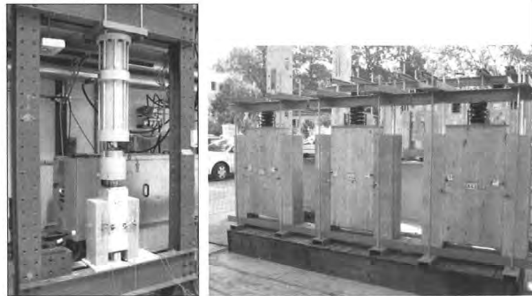
Bild 9: Aufbau der dynamischen Scherversuche und der Langzeitversuche im Freien (überdacht) mit Messequipment (aus [10])
