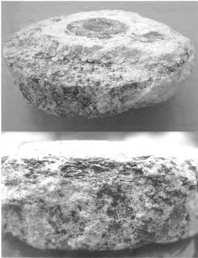
Bild 7 Ringkeildübel GD- \text{AlSi9Cu3} aus tausalzbehandelter Holzbrücke nach 5 Jahren
