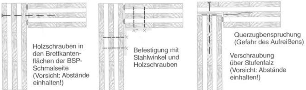
Abb. 3-3: Kontaktfuge Wand-Wand: Möglichkeiten der Schraubverbindung von Eckstößen
