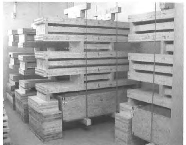
Bild 10 Test setup: Vier Kriechtürme in einer Klimakammer
