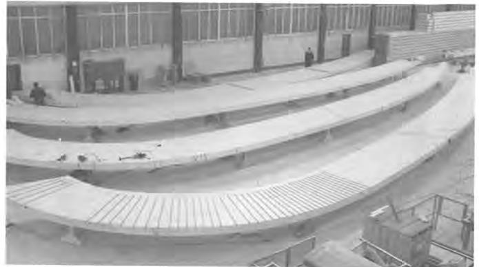
**Bild 1 Aufnahme von Querzugkräften durch Gewindestangen**
