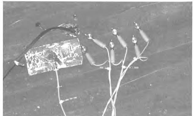
Bild 8 Anordnung von Elektroden zur Holzfeuchtemessung in 5 mm, 25 mm und 70 mm Tiefe sowie Thermoelement und Feuchte-Temperatur-Sensor
