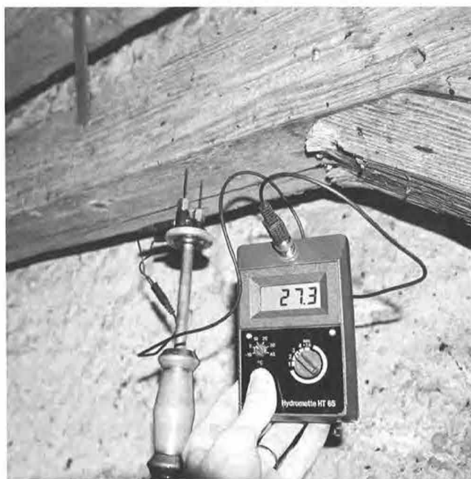
Bild 2: Holzfeuchtemessung über den elektrischen Widerstand.
