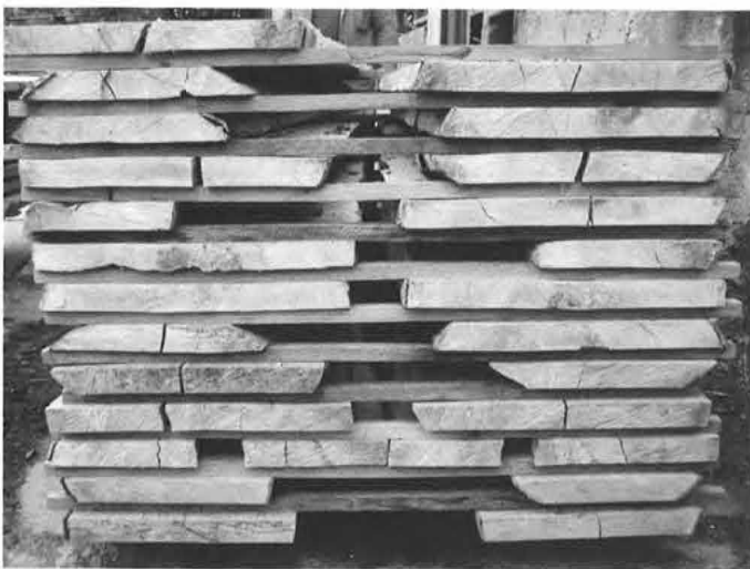
Bild 2: Unbesäumte Buchenbretter auf dem Kastenstapel als Ausgangsmaterial (links) und handwerkliches Besäumen auf fixe Breite (rechts)
