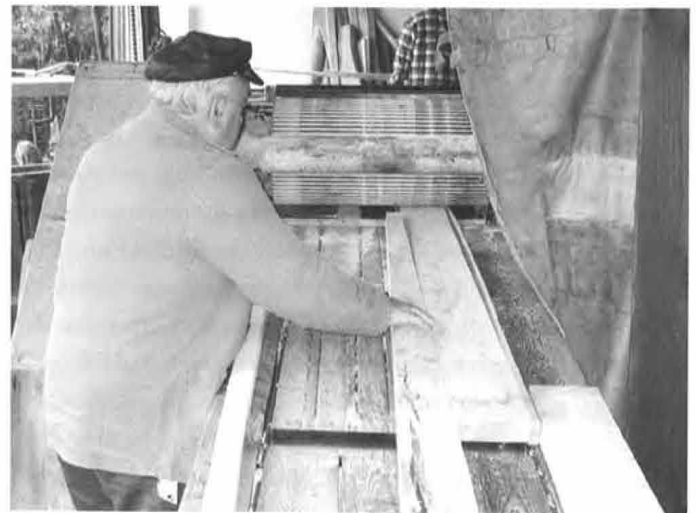
Bild 2: Unbesäumte Buchenbretter auf dem Kastenstapel als Ausgangsmaterial (links) und handwerkliches Besäumen auf fixe Breite (rechts)
