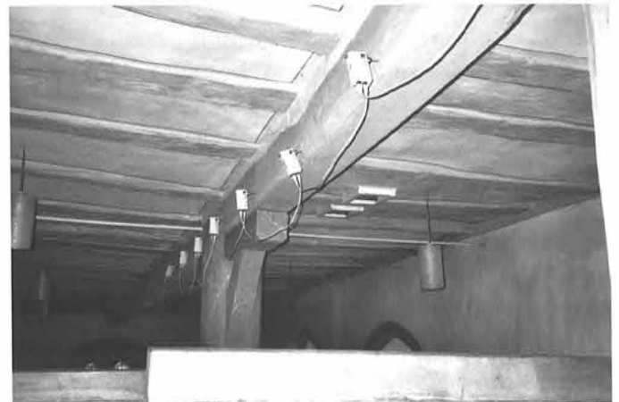
Bild 46: Sensoren an einem Unterzug zur Messung der Schallgeschwindigkeit in Faser-Längsrichtung.
