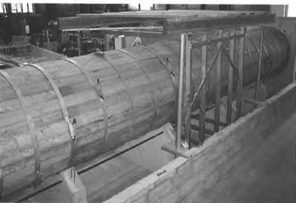
Bild 9: Versuchsstand zur Untersuchung des Biegetragverhaltens von Druckrohrleitungen aus Holz
