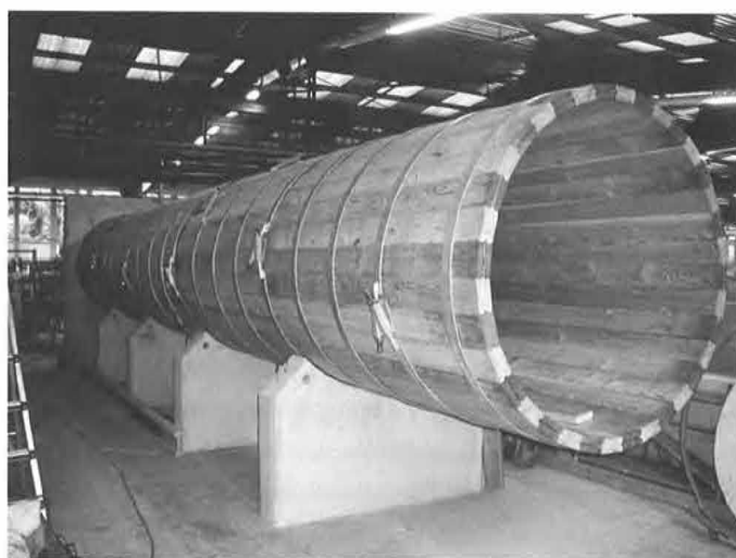
Bild 6: Aufbau einer Druckrohrleitung aus Holz (Versuchsstand)
