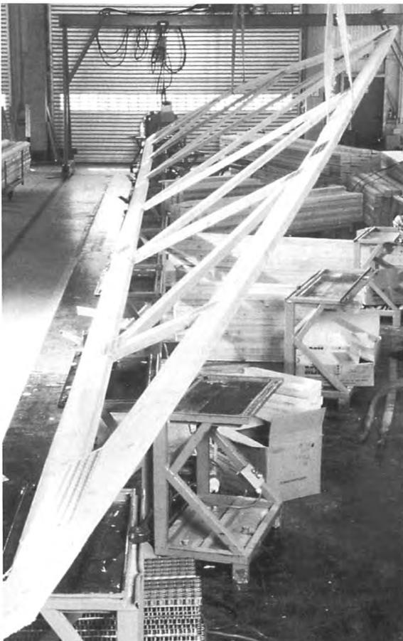
Bild 1: Nagelplattenbinder
