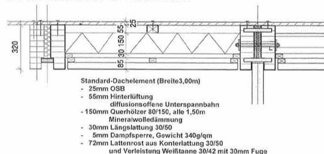
Bild 9: Dachelemente als Folienabsorber
