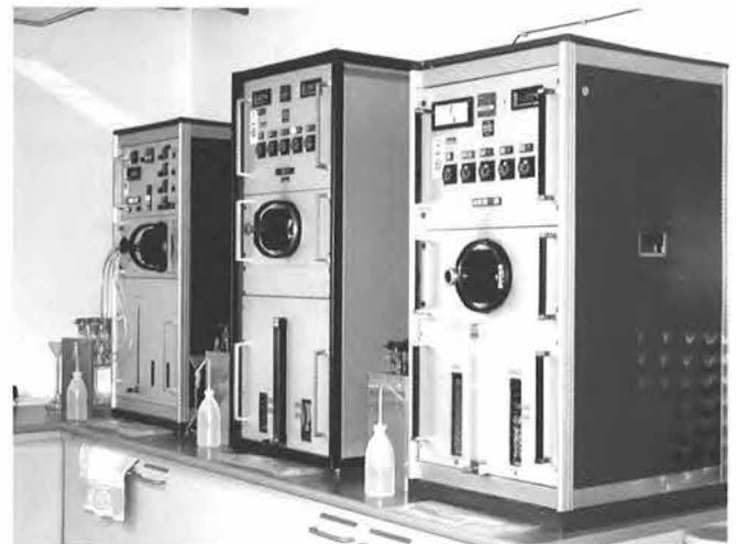
Bild 4: Gasanalysegeräte des WKI. Die Emissionsmessung des Formaldehydgehalts bei Sperrholz und beschichteten Platten ist bei den werkseigenen Produktionskontrollen Pflicht.
