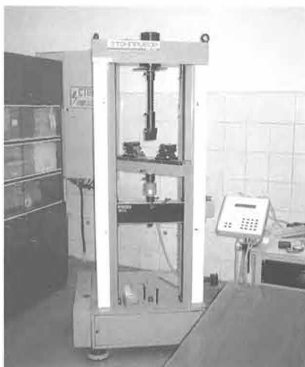
Bild 5: Biegeprüfung von Sperrholz in Russland. Auch die ausländischen werkseigenen Produktionskontrollen garantieren den europäischen Qualitätsstandard und ermöglichen die CE-Kennzeichnung.
