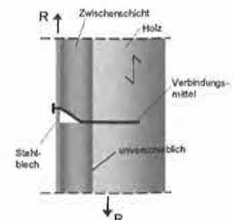
Bild 3: Möglicher Versagensmechanismus bei einer dicken Zwischenschicht
