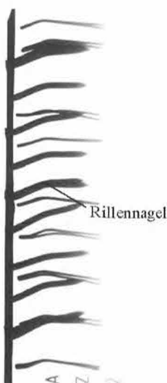
Bild 9: Röntgenaufnahme eines Versuches der Reihe B1
