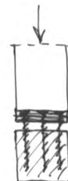
Bild 24: BVD-Verbindung: kreuzweise Pass-Bolzen, Behinderung des Spaltens durch „Umreifung“ mit Klemmscheiben
