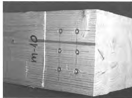
Bild 10: Auflager eines BSH-Trägers mit sechs Vollgewindeschrauben
