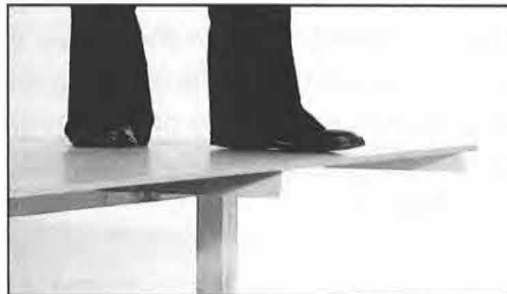
Bild 2: gute Festigkeitseigenschaften von MDF erhöhen auch die Sicherheit im Dachbereich; die Platten sind - im trockenen Zustand und bei üblichen Sparrenabständen - durchtrittssicher
