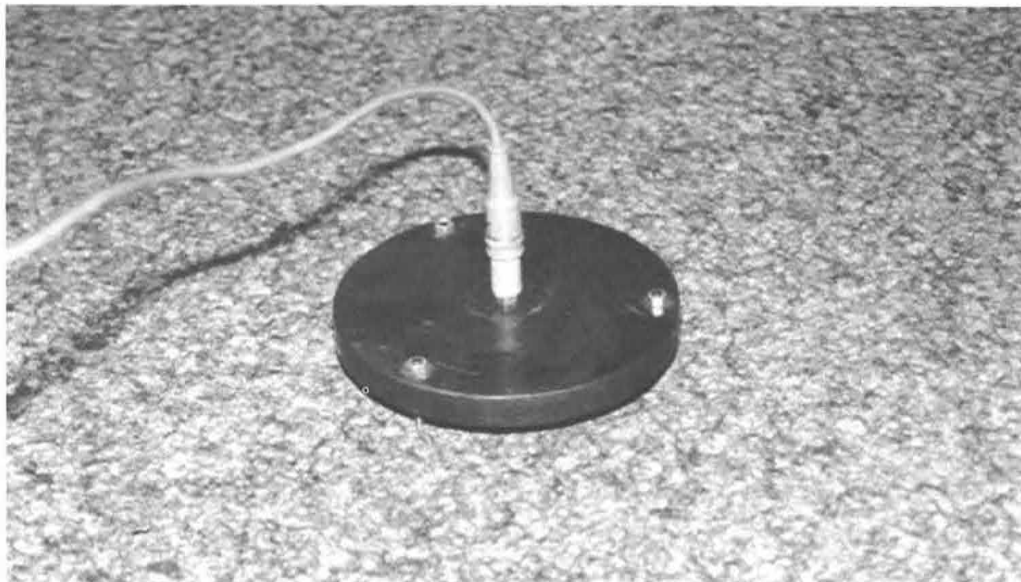
Bild 8: Beschleunigungsaufnehmer zur Bestimmung vertikaler Schwingungen
