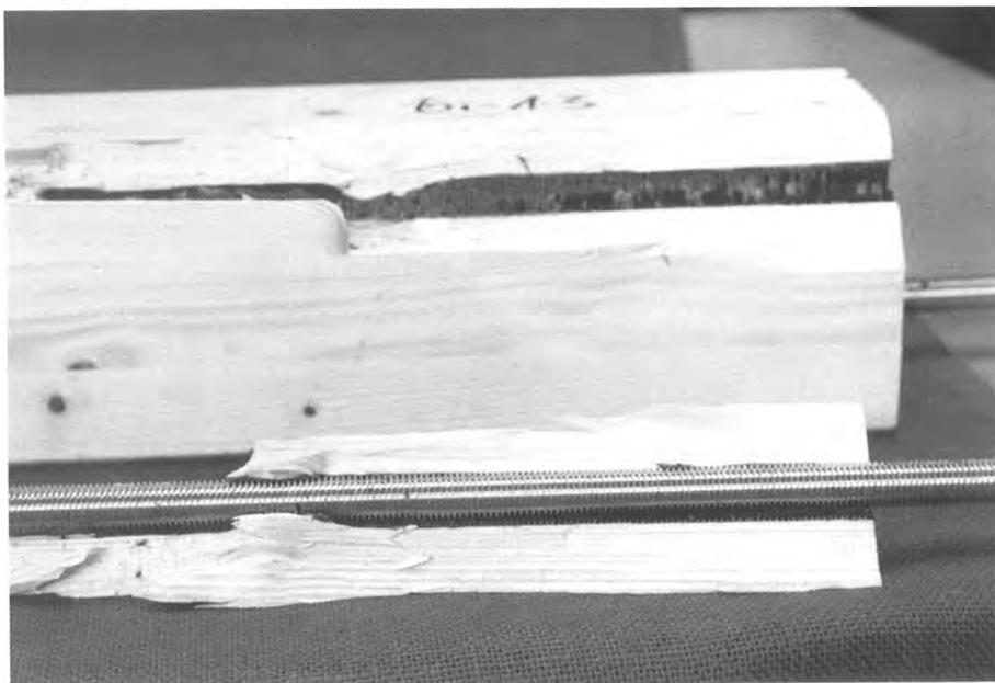
Abb. 1 Versagen der Adhäsion zwischen Kleber und Stahlstab
