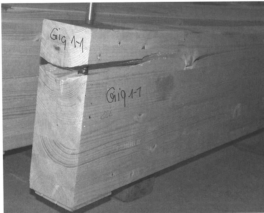
Abb. 5 Quersugversagen des Holzes durch Kraftkomponenten rechtwinklig zur Bauteilachse
