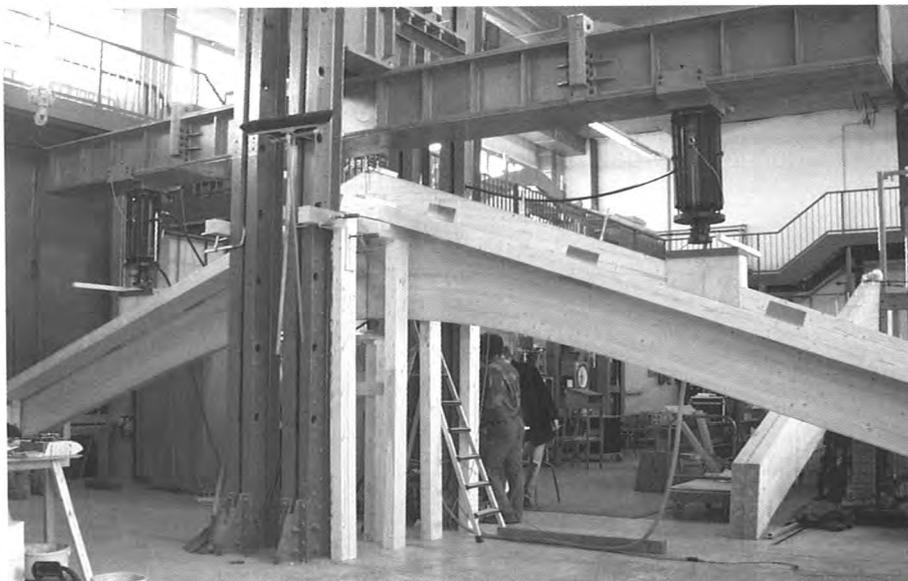
Abb. 8 Versuchsaufbau zur Prüfung eines Satteldachträgers
