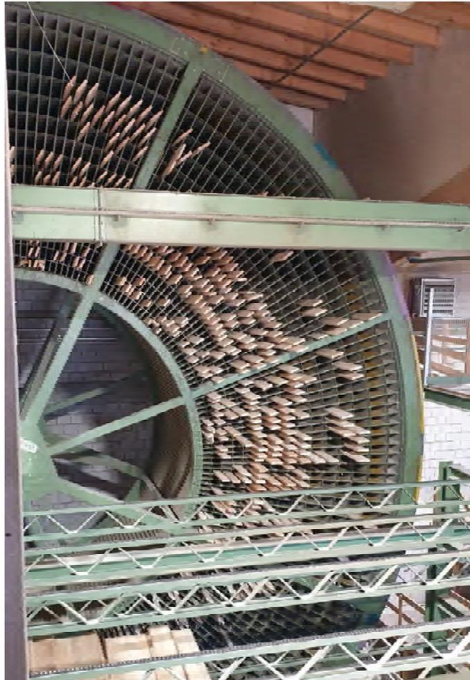
**Abbildung 12:** Sortierwerk der zugesägten Lamellen im Sägewerk.
