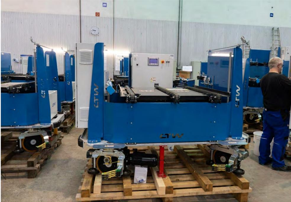
**Abbildung 7:** LTW Intralogistics – Regalbediengerät.
