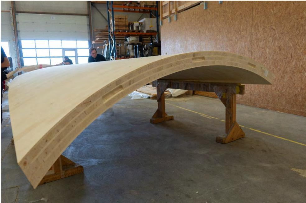
**Abbildung 13:** Frisch gepresste CLT-Freifform.
