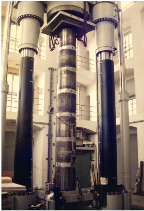
Bild 7 Stütze des Berliner Hauptbahnhofs in der Prüfmaschine Column of Berlin's main station in the testing machine
