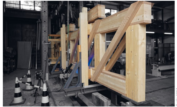
Bild 10 Großversuch an hybridem Fachwerkträger im Holzbaulabor Large experiment on hybrid timber truss in the timber construction laboratory
