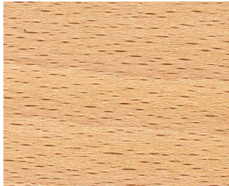
Abb. 1: (Einzelabbildung) Tangentialschnitt Buchenholz [2].
