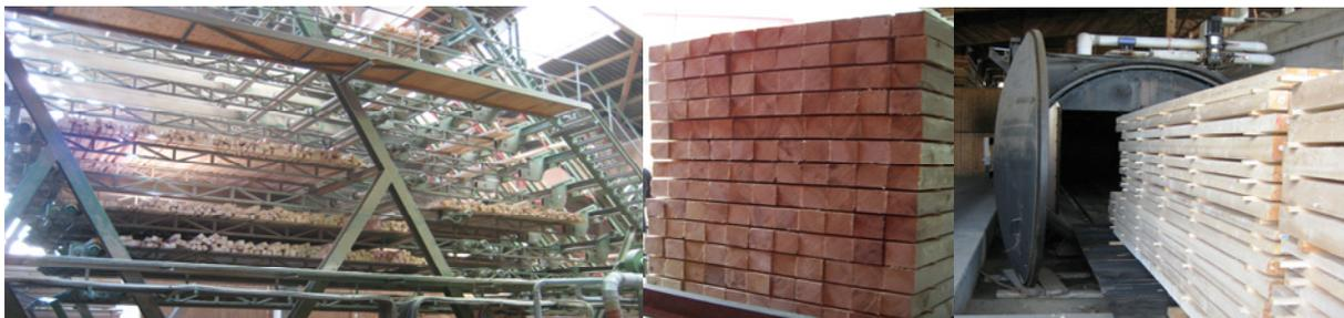
Seit 1989 stellt die Schilliger Holz AG Leimholzprodukte her, wie beispielsweise Brettschichtholz (BSH). Es ist in Abmessungen von bis zu 50 m Länge und Querschnitten bis 260 x 2000 mm erhältlich, was die möglichen Abmessungen von Vollholz weit übertrifft. Mit Brettschichtholz lassen sich auch gekrümmte Träger herstellen. Zu den Vorteilen von Brettschichtholz gehören außerdem die schnelle Verfügbarkeit (es ist im Extremfall innerhalb von 2 Tagen lieferbar) und der geringe Rissanteil.
