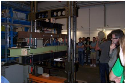
die Einsetzbarkeit von thermisch vorbehandeltem Holz zu erfassen. Die Proben bestehen ausschließlich aus astreinem Buchenholz und werden in einem Vierpunkt-Biegeversuch geprüft. Aus den gemessenen Verformungen und den aufgebrachten Kräften können die Steifigkeits- und Festigkeitswerte errechnet werden.
