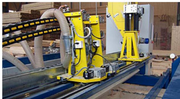
Im dritten Schritt werden die AppenzellerHolz-Elemente in Form gebracht. Es werden mit einer weiteren vollautomatischen Maschine u.a. Konturen gesägt, Steckdosen gebohrt, Verbindungsnuten gefräst und die Elemente auf die genaue Dicke kalibriert. Ein weiterer Arbeiter überwacht die Fräse und räumt Sägeabfälle beiseite.
