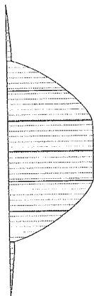
Bild C-5: Schubspannungsverlauf \tau nach Schubanalgie
