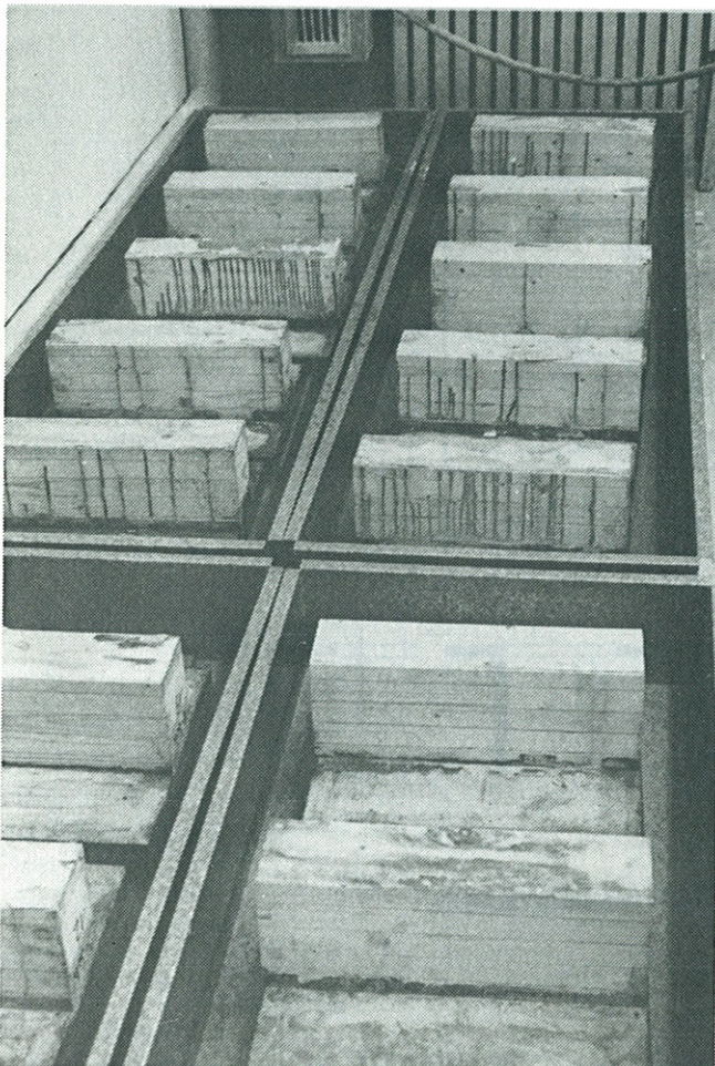
Abb. 9 Wasserlagerung der Betonplatten nach dem Ausschalen bis zum 7. Tag nach dem Betonieren.
