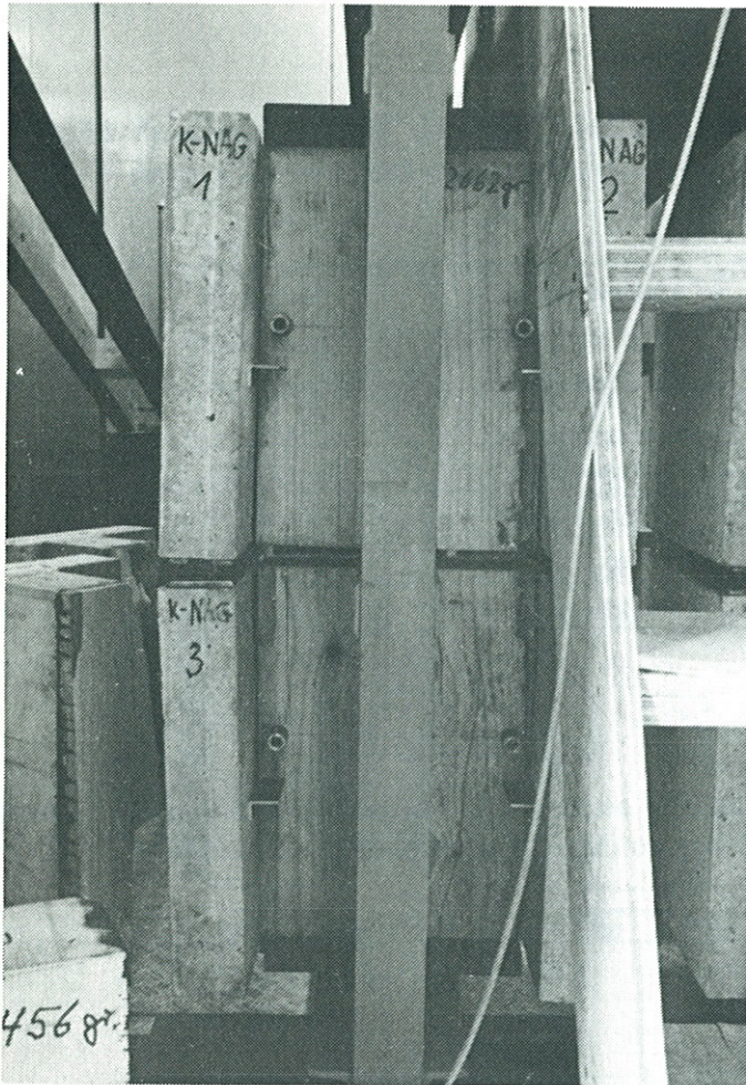
Abb. 54 Übereinander angeordnete Prüfkörper mit Nagelplatten-Verbindungen.
